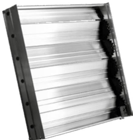
Клапан расхода воздуха изготовлен из алюминиевого профиля в виде рамки и горизонтально расположенных жалюзи, связанных между собой механизмом регулирования. Регулировка производится стандартной крестовой отверткой с лицевой стороны смонтированного изделия. Клапан устанавливается на внутреннюю часть рамки вентиляционной решетки и жестко крепится заклепками. Клапан расхода воздуха позволяет плавно и равномерно распределять и регулировать воздушный поток.
